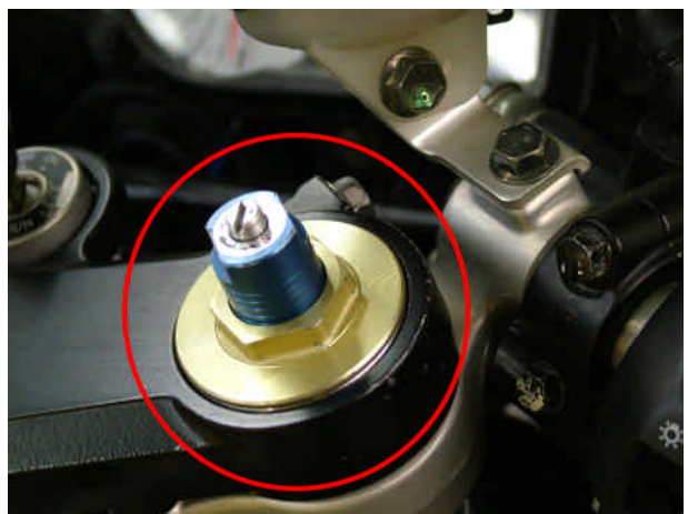
Federvorspannung und Dämpfereinstellung der Gabel
