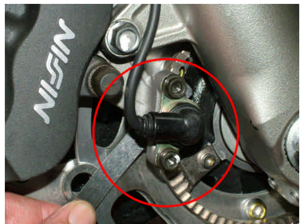
Prüfen des Luftspaltes zwischen Radsensor und Segmentrad.
