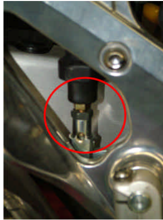
Anpassung der Pedalstellung an der Kolbenstange
