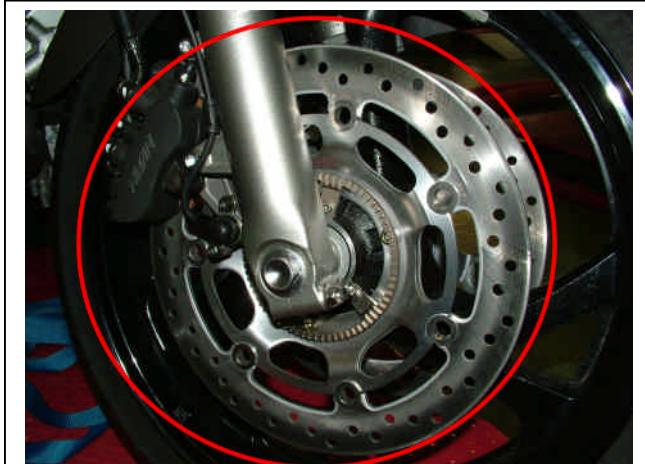
Prüfen der Bremsanlage auf Undichtigkeiten
