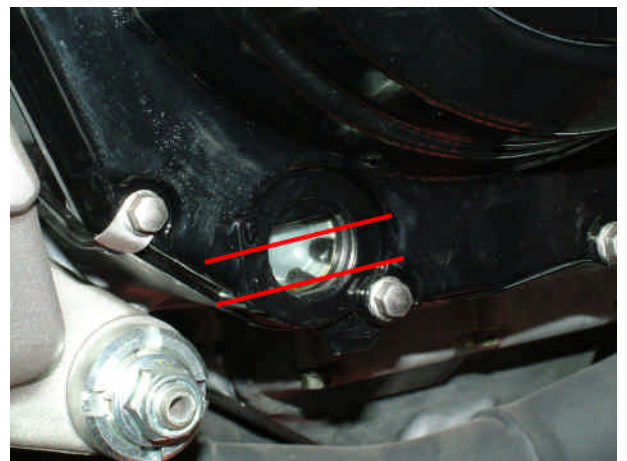
Ölstand unter Minimum
