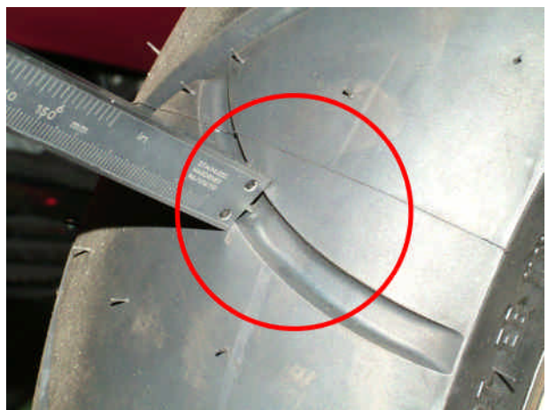
Messen der Reifenprofiltiefe in einer Hauptprofilrinne
