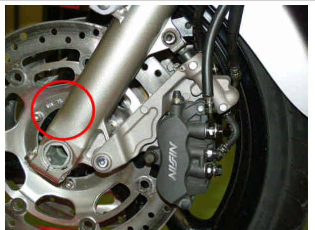
Markierung der Mindestscheibendicke
