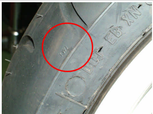
TWI oder Dreieck-Markierung am Reifen
