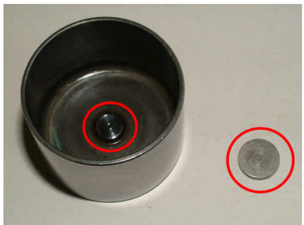
Tassenstößel mit Ventilshim
